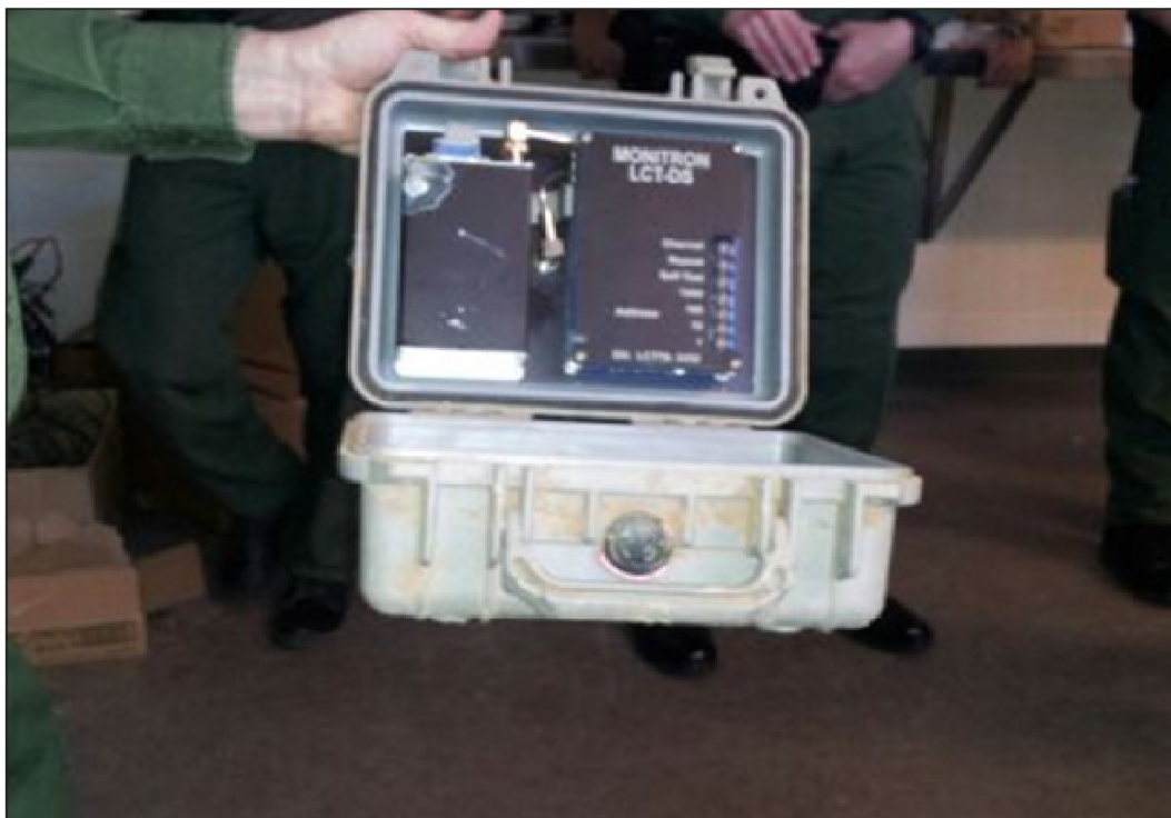
Figura 16 - Sensores de Chão que não demandam atenção
